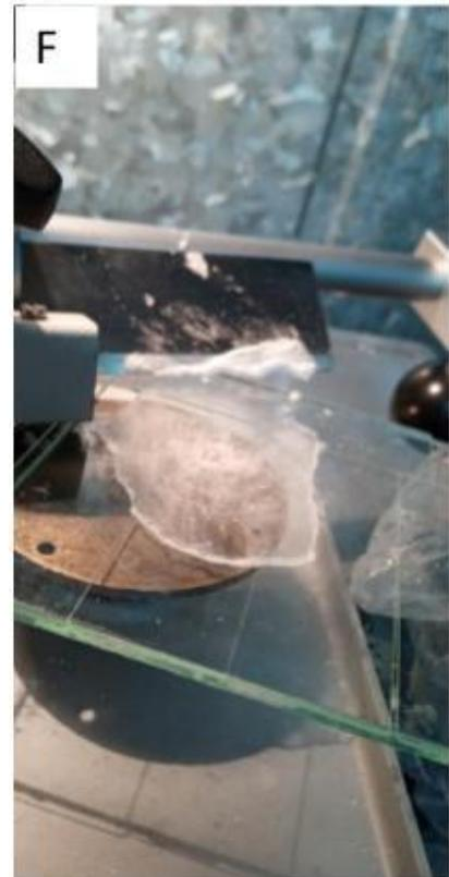
Figura 1. Procedimiento de seccionado de la muestra a  $-12^{\circ}\text{C}$  – A-C ) muestra pegada por fusión superficial y cortada mediante una sierra circular. D) Lámina gruesa cuya superficie es desbastada a espejo mediante un micrótopo. E) la lámina gruesa es pega a un portaobjeto, por fusión-solidificación suave, de la superficie, F) desbaste mediante micrótopo para obtener la lámina delgada a sublimar G) muestra de 9 cm de diámetro máximo
