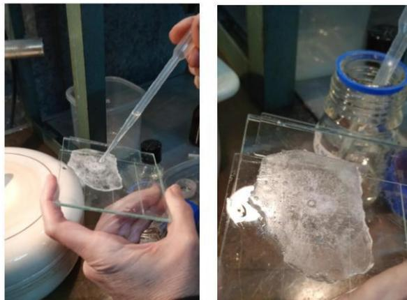
Figura 3 Procedimiento de recubrimiento de la fina película de Formvar para sublimar
