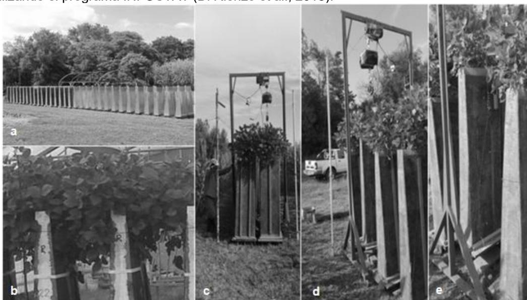
*Figura 1.* Prototipo de plataforma de fenotipado para estudios de estrés hídrico (a); Canopeo generado por las plantas en la plataforma (b); Estructura para el pesado de macetas (c); Puente grúa con aparejo levantando (d); Lisímetro levantado (e).
