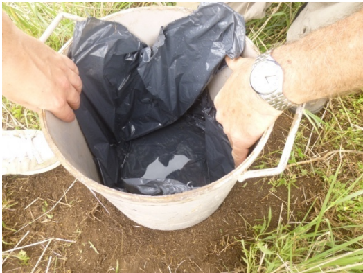
Figura 3: Cubra con una lámina de plástico, el anillo y la superficie del suelo dentro del anillo
