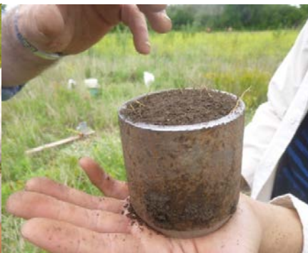
Figura 10: Remueva exceso de suelo
