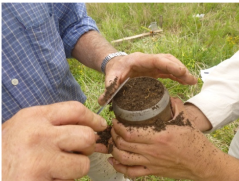
Figura 9: Remueva exceso de suelo
