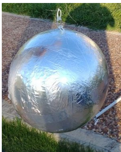
Figura 4.3: Esfera recubierta con aluminio de 46 cm de diámetro.
