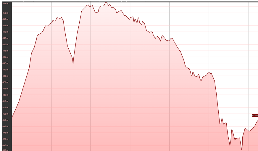
Figura 4.9: Perfil de elevación de terreno descrito por un círculo de 2500 m de radio centrado en el RMA1.
