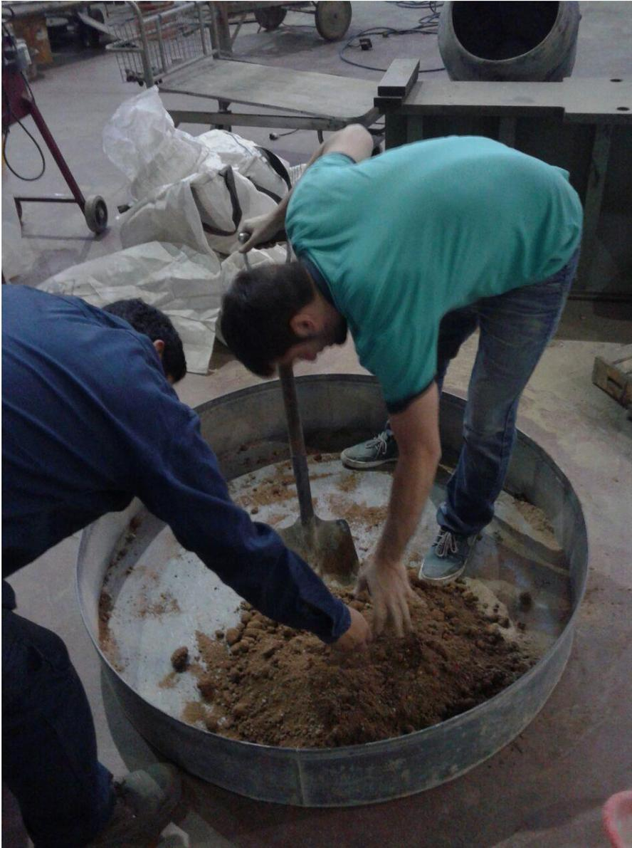
*Imagen 5 Control de consistencia de la mezcla*
