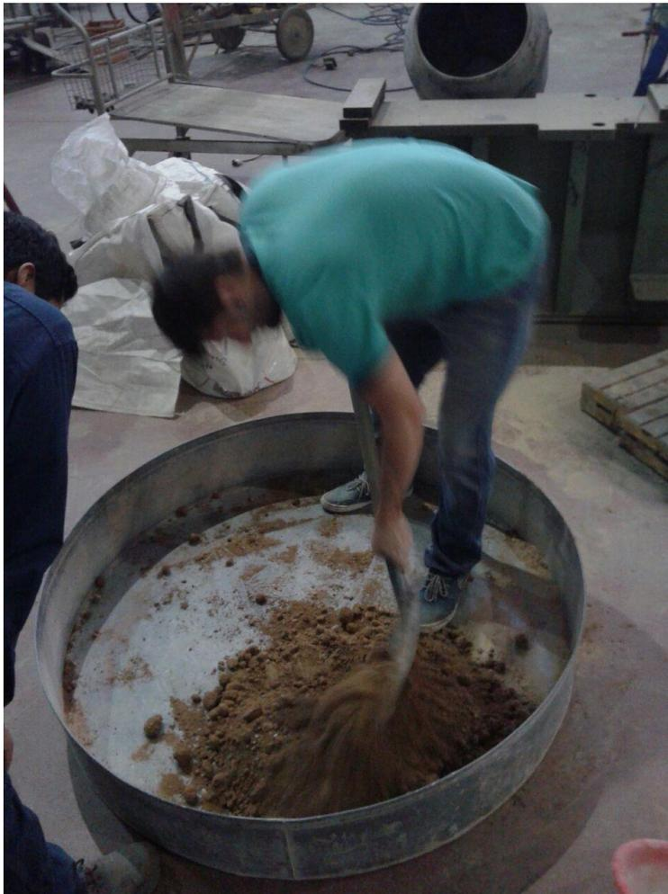
*Imagen 4 Homogeneización de la mezcla*
