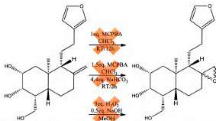
Esquema 4.7: Reacción de formación del epóxido por tres métodos diferentes.
