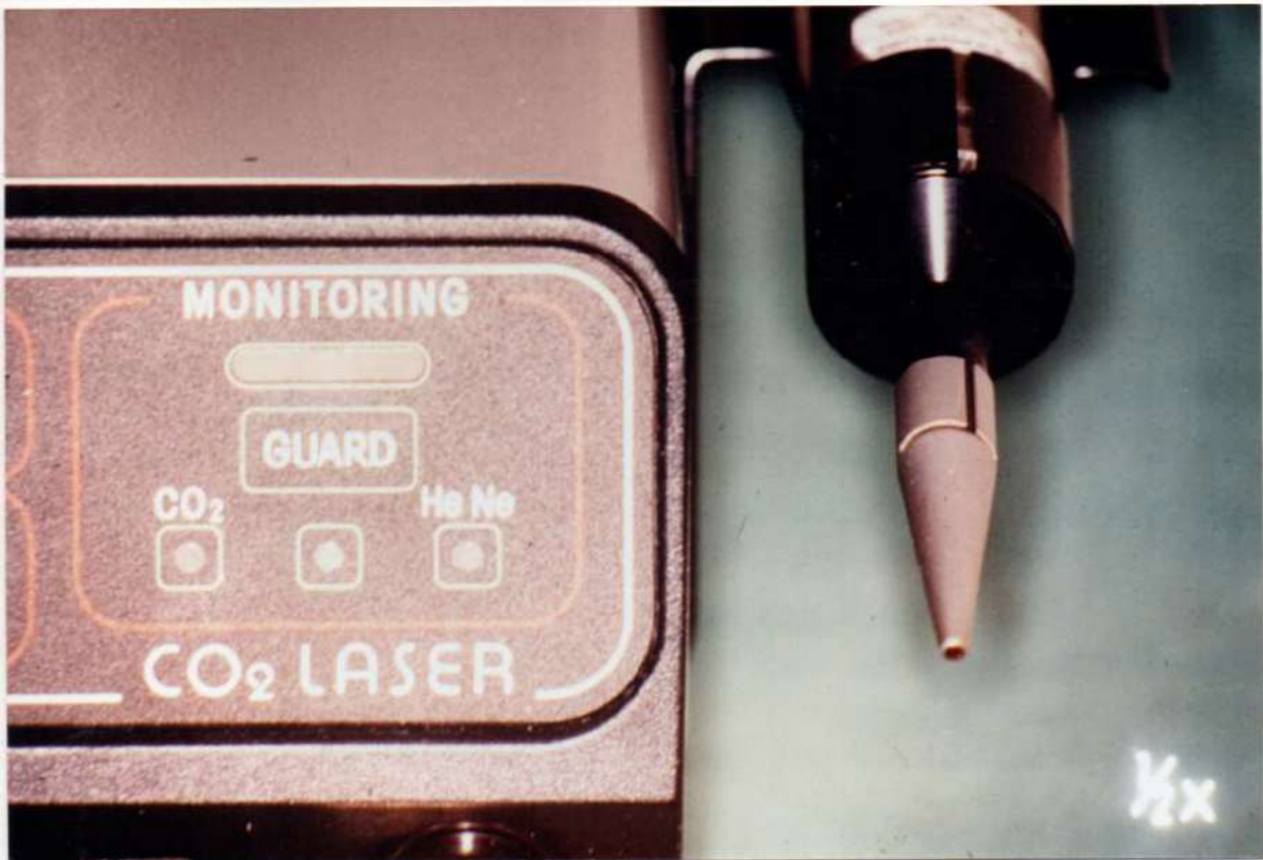
Figura 4: El monitoreo del Laser de CO_2 y del Laser de He-Ne coaxial marcador del impacto fotónico.
