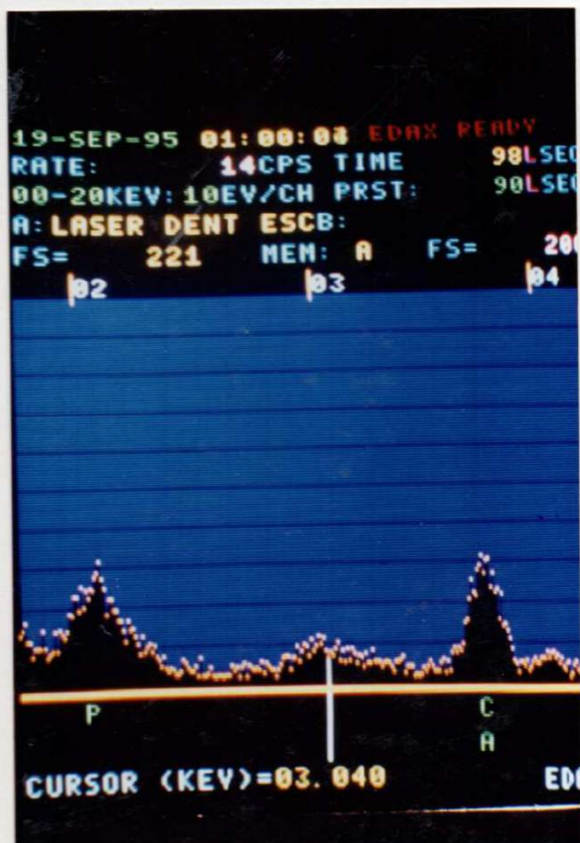
Figura 107: Espectro de Emisión Edax del Balance Fósforo -Calcio en dentina laseada con escara negra.
