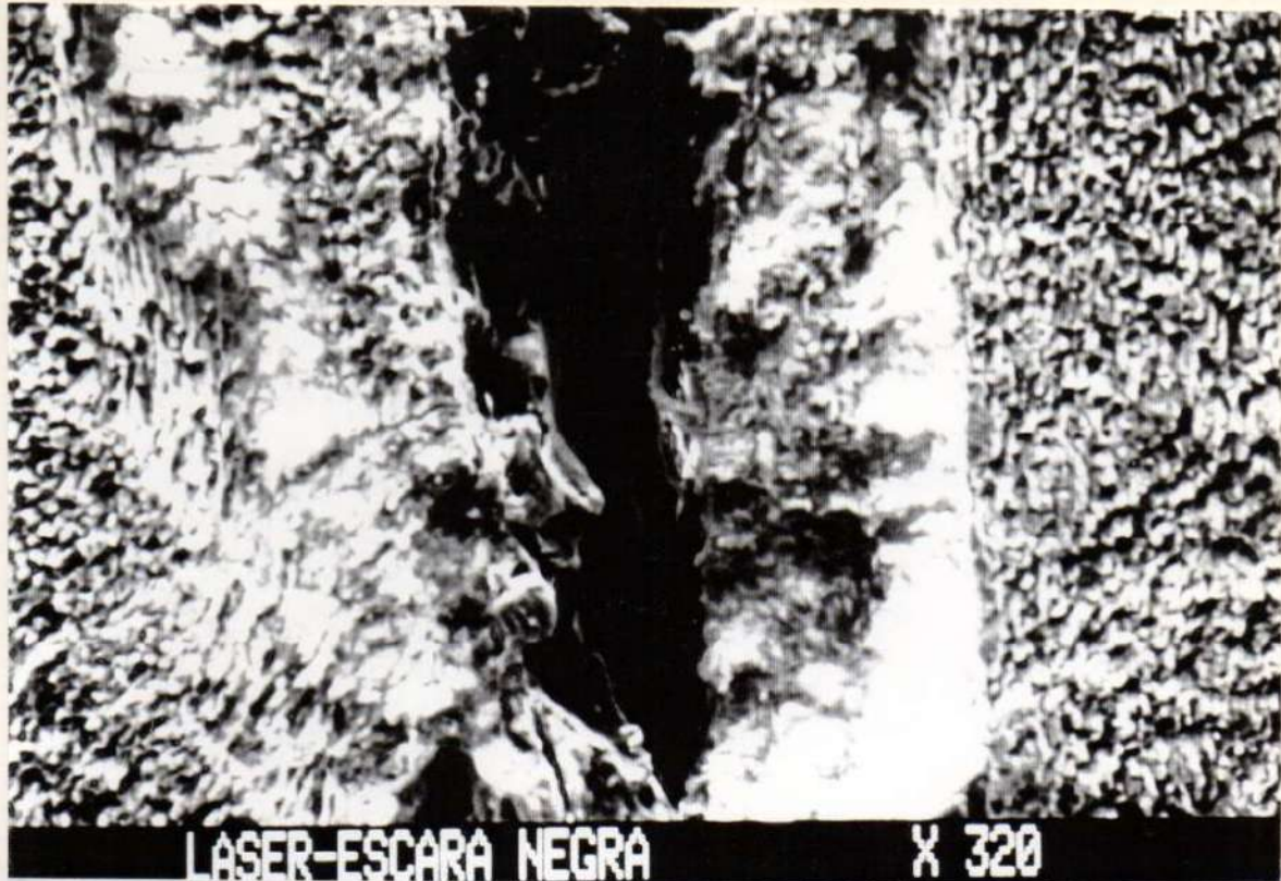
Figura 57: Micrografía con MEB a 320 micrometros en la que se observan áreas de recristalización-fusión y escara negra en la profundidad del surco. Laseado con Laser de CO 2 .
