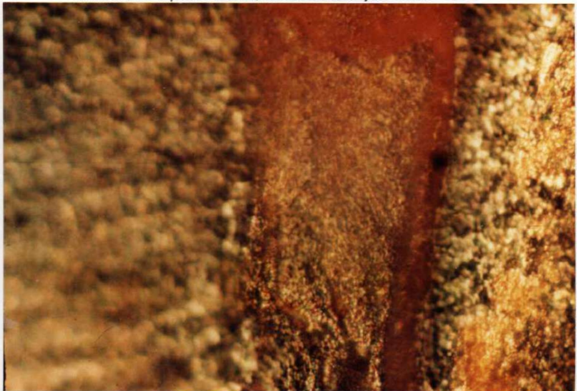
Figura 50: Microfotografía de la zona de fusión -recristalización de la figura anterior a mayor amicrometrosento. X 360.
