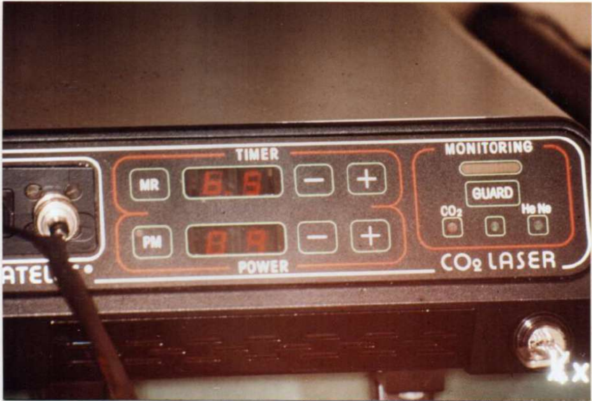
Figura 3: Consola de comando del Lasersat, Laser odontológico de Satelec-Francia, donde se puede observar el microprocesador regulador del tiempo en segundos y de la potencia en Watts.
