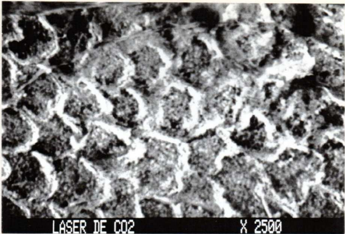
Figura 36: Micrografía correspondiente a la zona de fusión-recristalización adamantina laseada, de la figura anterior a X 2.500.
