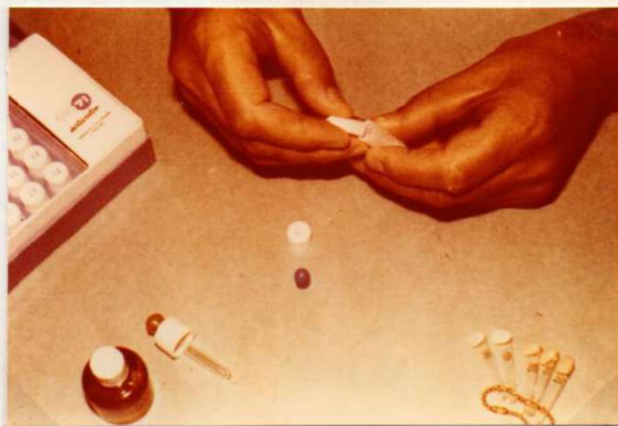
Figura 24 Agregado del catalizador a la cápsula grande de resina.
