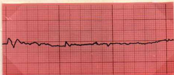
Figura 145 Registro gráfico de la textura superficial determinada por una matriz de acetato de celulosa, en un composite del grupo B.
