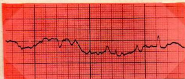
Figura 185. Registro gráfico de la rugosidad obtenida por pulido con fresa de 12 hojas en una resina compuesta del grupo B.
