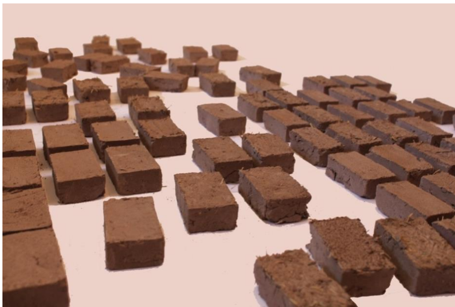
16. Ladrillos de adobe para maqueta
