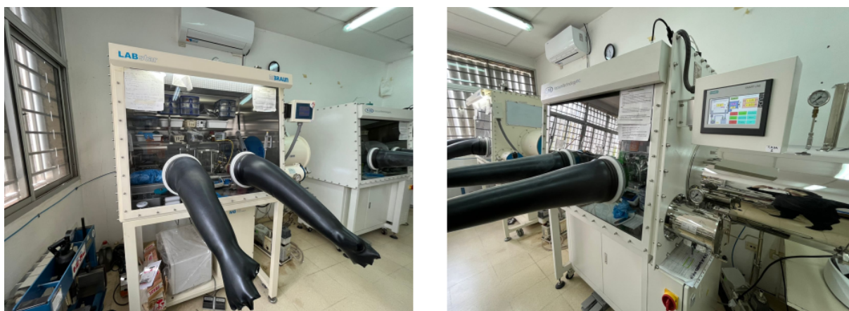
Figura 2.1: Fotografías de las cajas secas del Laboratorio de Energías Sustentables. A la izquierda la caja marca M-Braun, modelo MB10 compact; a la derecha, la caja marca Vacuum Technology Inc. Modelo Super 1220/750/900
