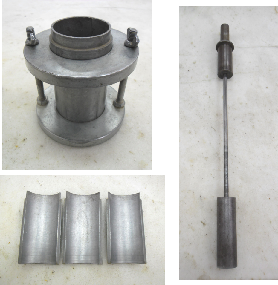
Figura 5.5. Molde de acero tripartido y pisón de acero de 0.80 kg. y una altura de caída de 39 cm.
