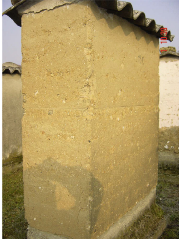
Figura 3.9: Muro construido con suelo estabilizado con cal, mediante la técnica de tapial o ramed earth (Bui et al., 2009).
