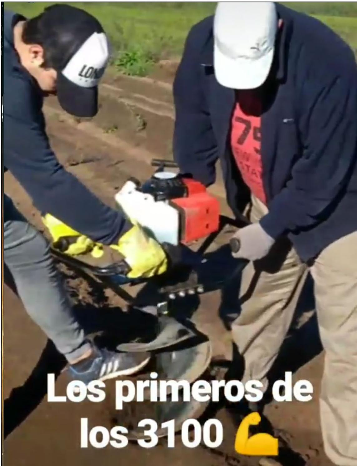
Figura 9 Tareas de hoyado mecánico con hoyadora manual, usada para primeros 3100 ejemplares
