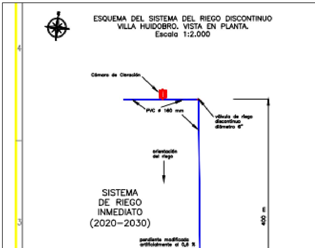
Figura 5. Esquema de sistema de riego discontinuo, vista en planta
