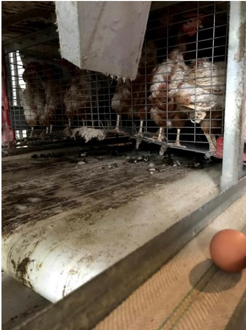
Figura 5 Cinta transportadora de heces por debajo de jaulas. Fuente: propia.
