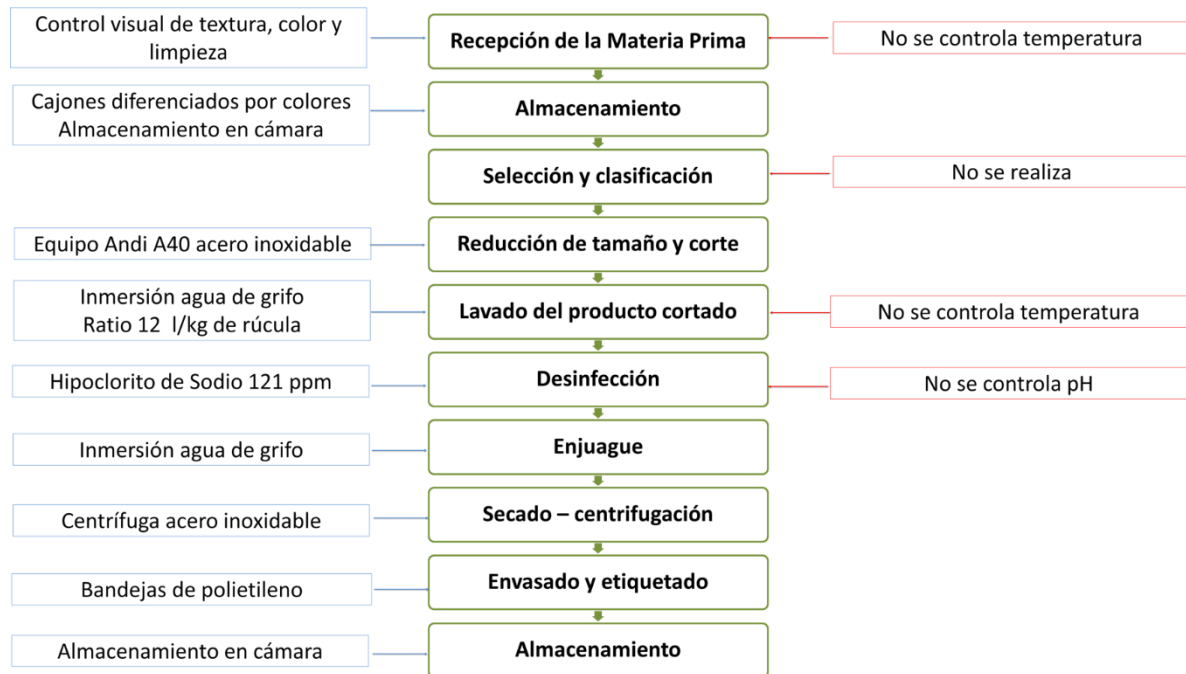
Figura 3.1. Diagrama de flujo del proceso de elaboración de rúcula lista para consumo en la Ensaladas Prácticas S.R.L. Izquierda: procedimientos aplicados. Derecha: deficiencia en el procedimiento.
