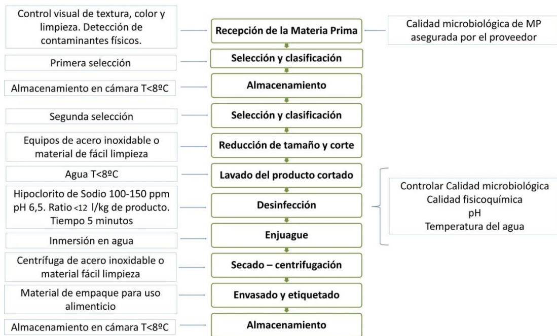
Figura 3.3. Diagrama de flujo del proceso de elaboración de rúcula lista para consumo optimizado
