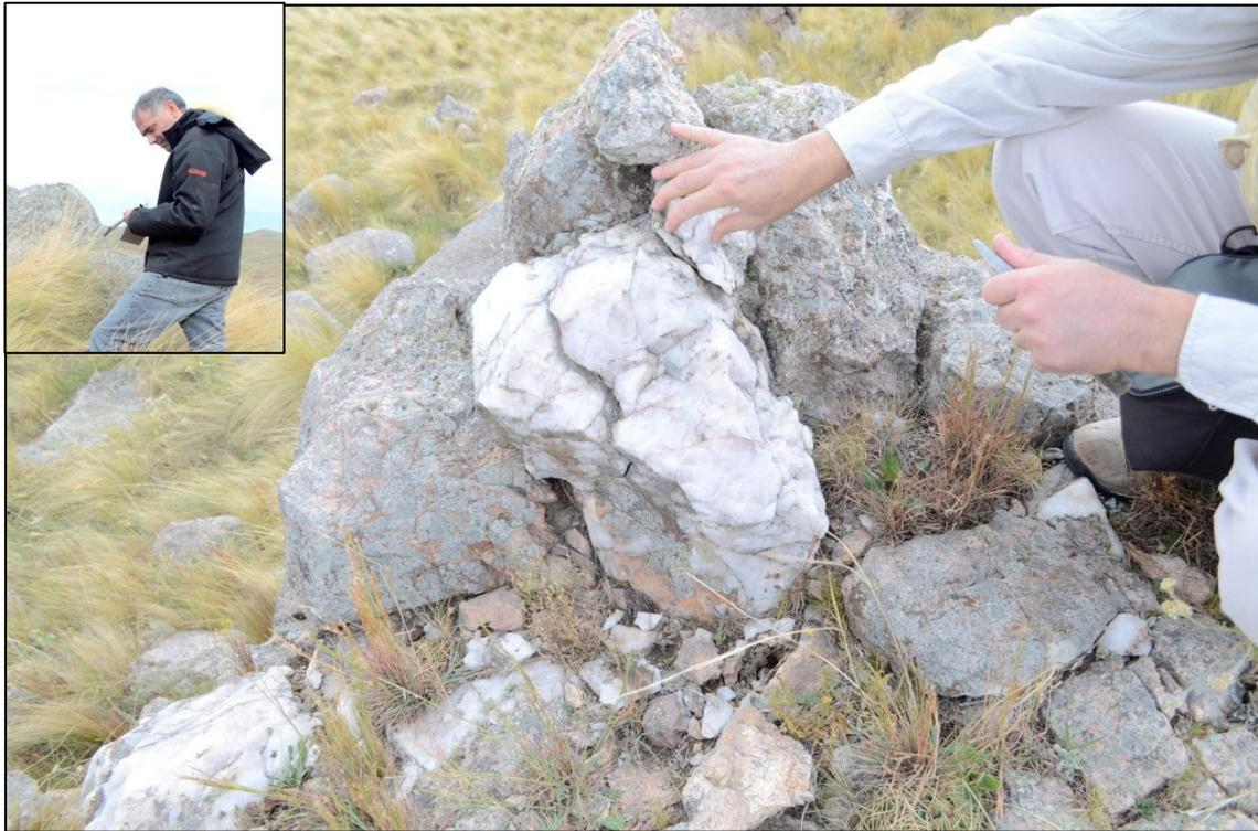
Figura 2.1. Extracción de muestra de mano y registro de las características geológicas del afloramiento en libreta de campo.
