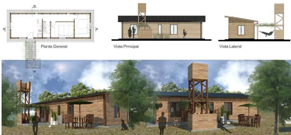
Figura N°39: Plantas, vistas y renders de la tipología lineal en Concordia (íntegramente en madera). (Fuente: Archivo documental del Programa de Investigación “Co-construcción del Conocimiento”).
