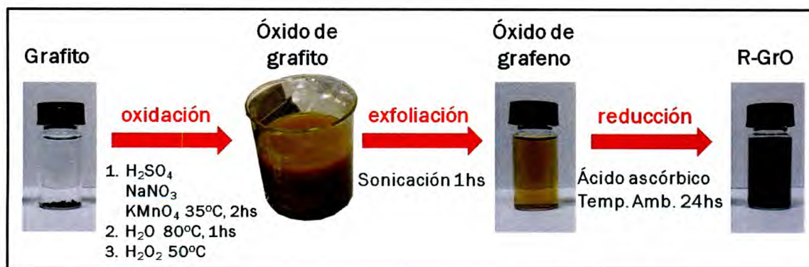
Figura 15. Representación esquemática de la síntesis química de R-GrO.
