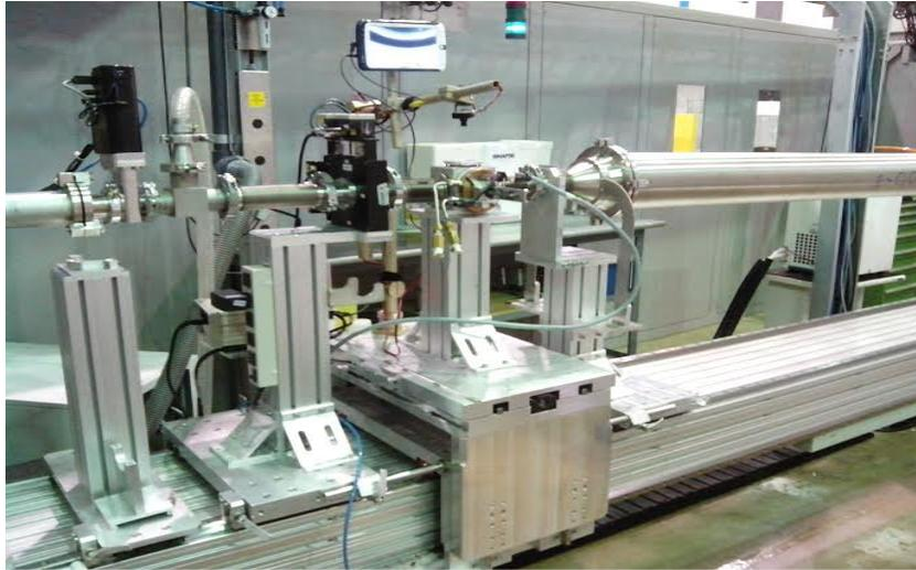
Fig. 10: Configuración experimental para la irradiación iónica
