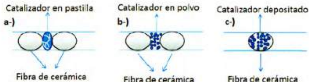
Figura 4.3. Arreglos experimentales de soporte del catalizador: a-) Catalizador en pastilla tamizada, b-) Catalizador en polvo y c-) catalizador adsorbido en el soporte de fibra de cerámica.
