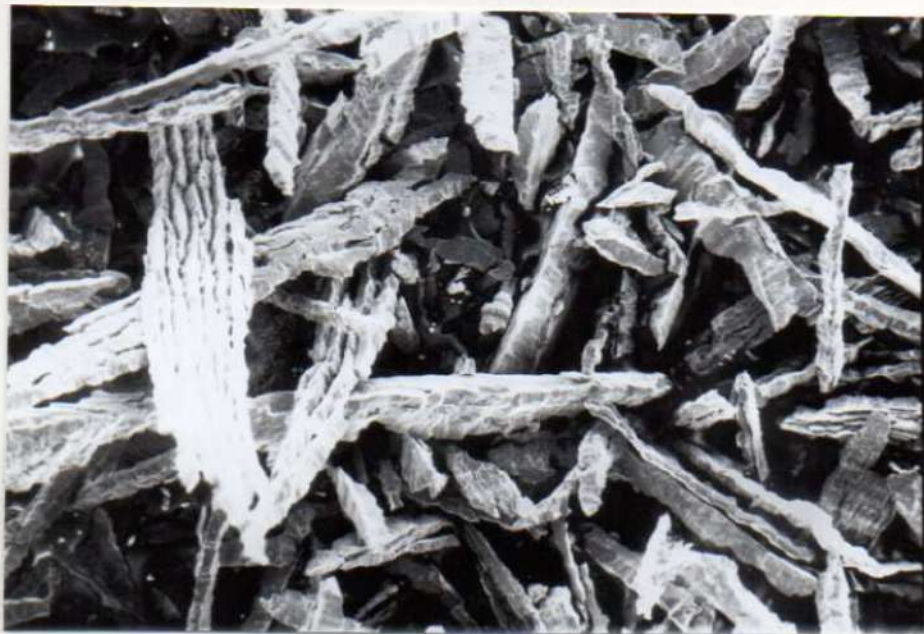
FIGURA 1. Limaduras de aleación convencional de macrocorte. Microfotografía obtenida con M.E.B. 100 X.
