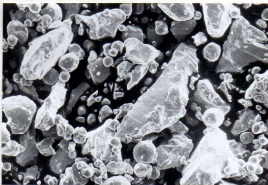
FIGURA 4. Aleación de fase dispersa, donde se observan las limaduras convencionales y las partículas esféricas con el eutéctico plata-cobre. M.E.B. 450 X.
