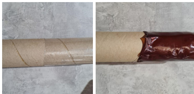
Figura 50: Tubo de cartón cubierto con PET de botellas descartables Fuente: Elaboración propia
