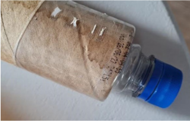
Figura 51: Extremo de tubo de carton con pico de botella PET
