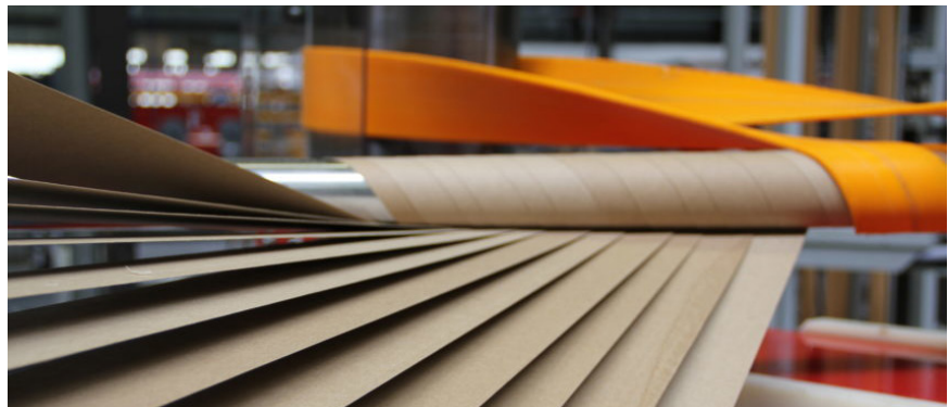
Figura 3: Proceso de fabricación de los tubos de cartón Fuente: https://cdn.shortpixel.ai/client/to_webp,q_glossy,ret_img,w_1903/https://www.tubosesbert.com/wp-content/uploads/2019/03/PROCESO-Banner.jpg
