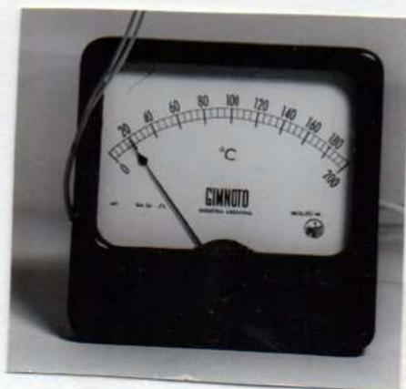
Figura 3: Electrogalvanómetro "GIMNOTO", con escala graduada en grados centígrados.
