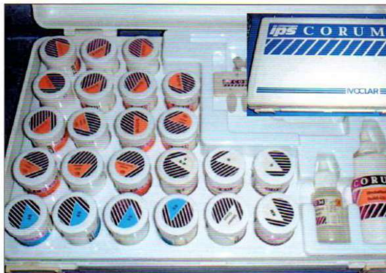
Figura 52: Avio de cerámica IPS Corum para la cocción convencional sobre revestimientos de las incrustaciones del grupo D.
