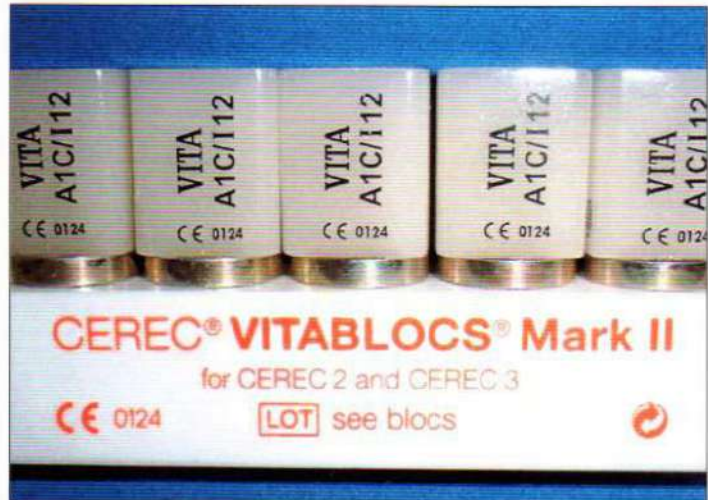
Figura 35: Bloques cerámicos CEREC Vitablocs Mark II para CEREC 2 y CEREC 3, seleccionados para el tallado de las incrustaciones.
