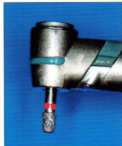
Figura 9: Contra ángulo Siemens Intramatic Lux 2 20LN y piedra diamantada 980.030 Cerafill, Komet utilizados para el tallado de las preparaciones cavitarias.
