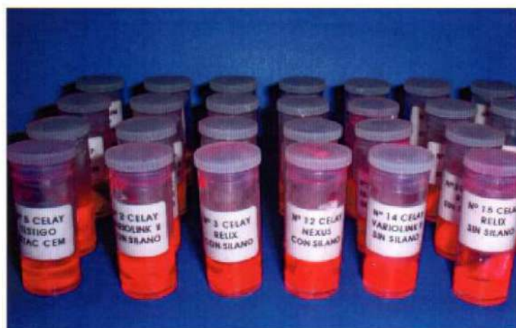
Figura 90: Inmersión de los cortes en Rodamina B al 1% para su observación con Confocal Laser Scanning Microscope (CLSM).
