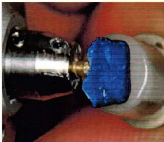
Figura 24: Verificación de la relación del tamaño de la pieza a tallar con el bloque de cerámica. Visualización frontal.
