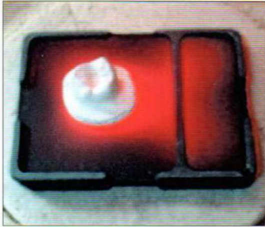
Figura 57: Eliminación de vapores del revestimiento mediante calentamiento en horno convencional y de cerámica.
