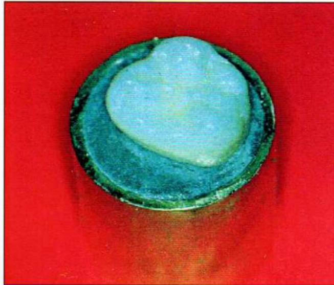
Figura 2: Inserción del elemento dentario en resina acrílica autopolimerizable para su inmovilización en el portamuestra.
