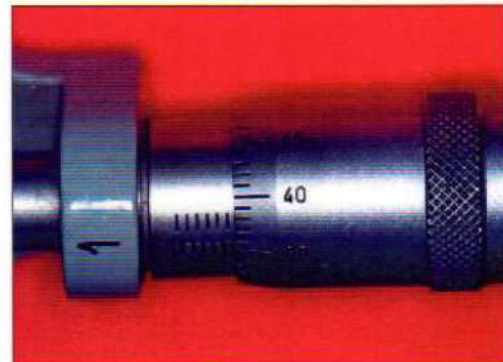
Figura 5: Tornillo micrométrico de la platina de movimientos para el guiado bidimensional de la trayectoria horizontal X-Y.
