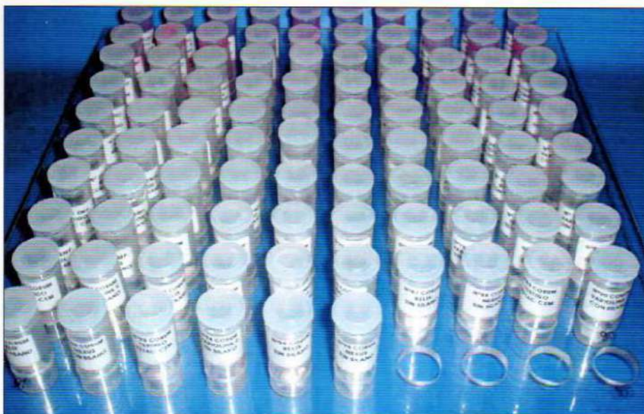
Figura 13: Conservación de las muestras en saliva artificial a 36.8 °C.
