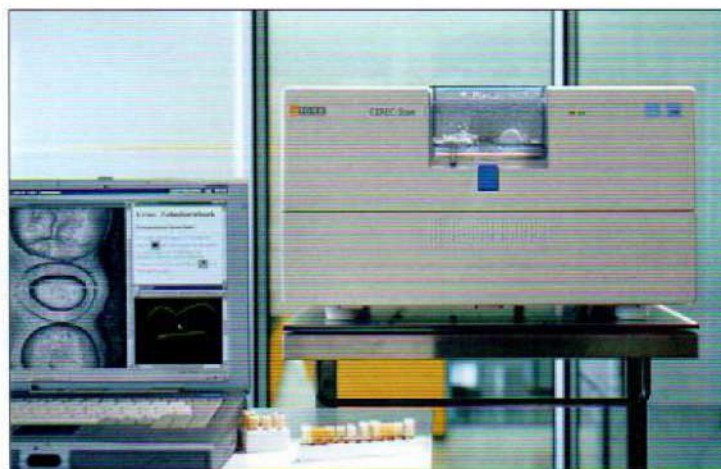
Figura 28: CEREC 3 Scan utilizado para la confección de las incrustaciones del grupo B por fresado con sistema CAD-CAM.
