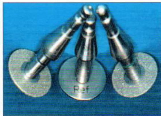
Figura 19: Disco liso de referencia de copiado y discos diamantados de grano grueso y fino empleados para el tallado de las incrustaciones.
