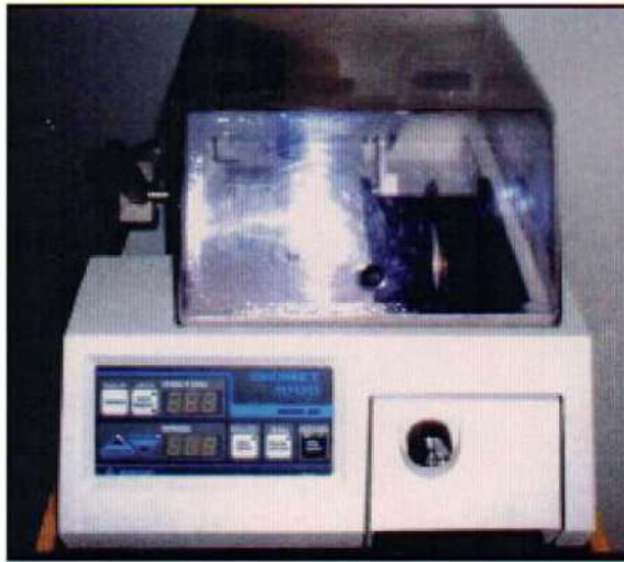
Figura 86: Microtomo ISOMET 1000 utilizado para el corte de los elementos dentarios.
