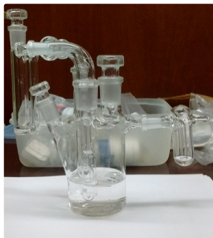
Figura 4.1: a) Celda de dos cuerpos preparada para contener tres electrodos y con dos accesos para gases en la solución y por encima de esta. b) Captura cercana del compartimento del electrodo de referencia y de la placa frita dentro de la solución.
