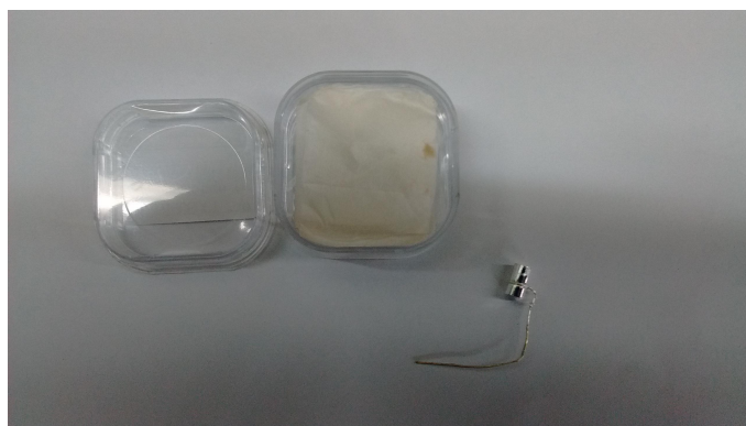
Figura 4.2: Electrodo de trabajo, en este caso una superficie Ag(11 11). El contacto es un alambre de plata de pureza 99,999%.
