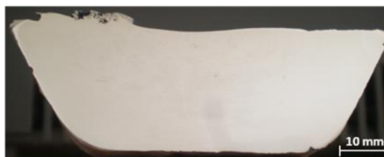
Figura 5. Macrografía a simple vista de la sección transversal del lingote.
