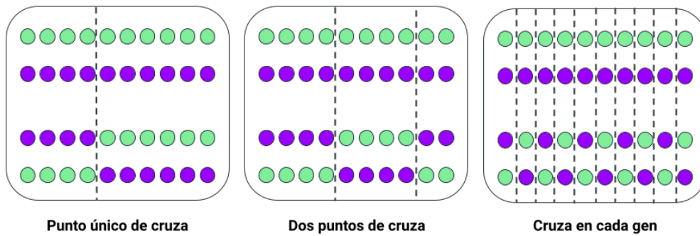
Figura 2.5: Esquema de los distintos métodos de cruce. De izquierda a derecha se muestran los métodos de: cruce en un único punto, cruce en dos puntos y cruce uniforme o punto a punto.
