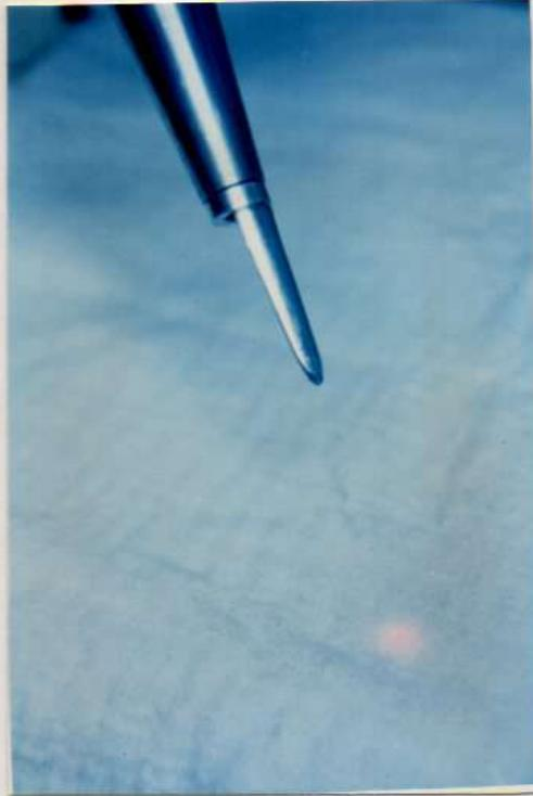
Fotografía N<sup>o</sup> 16: Detalle de la pieza de mano y luz gufa de Helio-Neón
