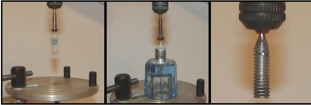
Fig.69-Poste posicionado en tangensiómetro.
