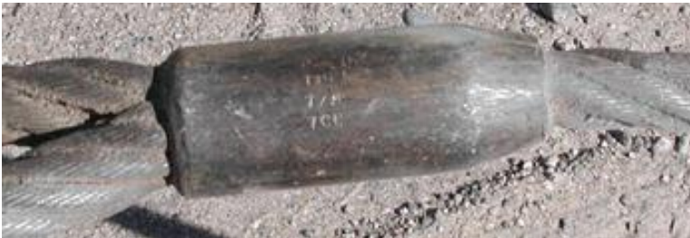
Fig. 4.2. Detalle de la capacidad de carga en eslingas de acero.
