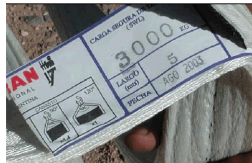
Fig. 4.4. Capacidad nominal de carga en eslingas sintéticas.
