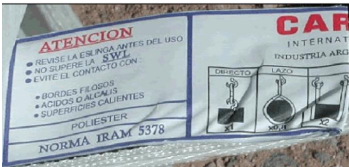
Fig. 4.3. Detalle de la capacidad de carga en eslingas sintéticas.
