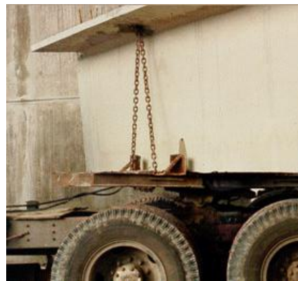
Fig. 2.13 Detalle de apoyos durante el transporte
