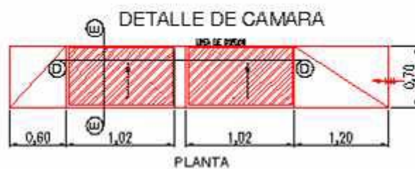
Figura 6: Detalle cámara en sumidero de rejillas.
