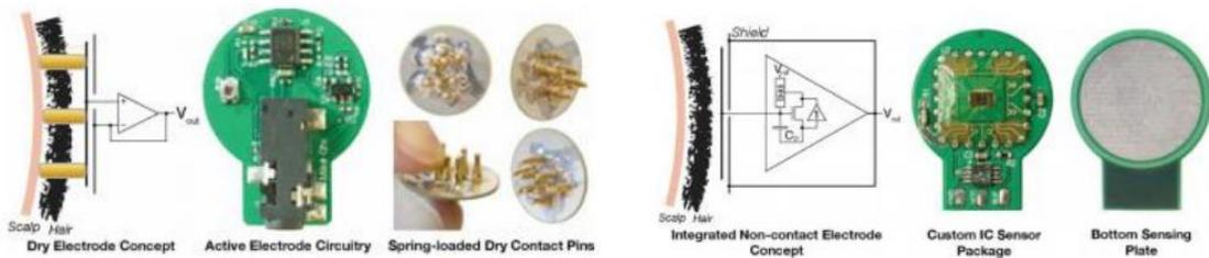
Figura 4: Ejemplo de electrodos secos para aplicaciones ICC. A la izquierda, electrodo seco con contacto con la piel del usuario, a la izquierda, electrodo seco sin contacto con la piel<sup>4</sup>.
