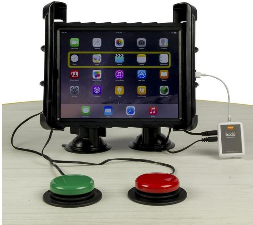
Figura 16: Sistema de barrido de pantalla con botones físicos.<sup>16</sup>
