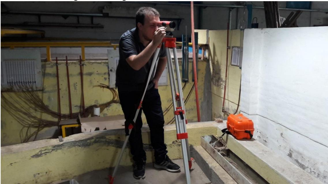
Figura 50. Medición del perfil de erosión con el nivel
