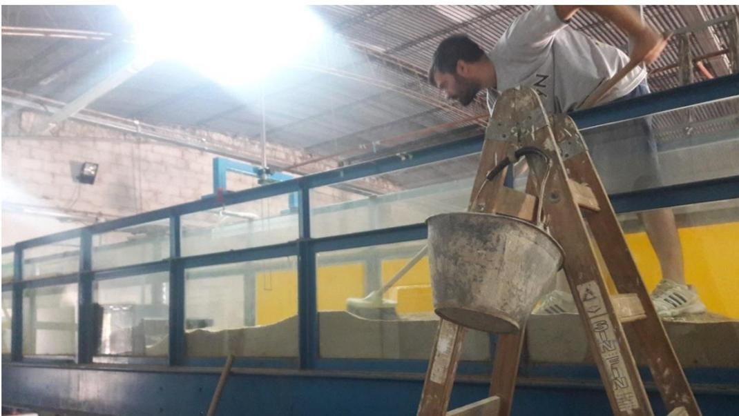
Figura 24. Distribución del sedimento en el canal
