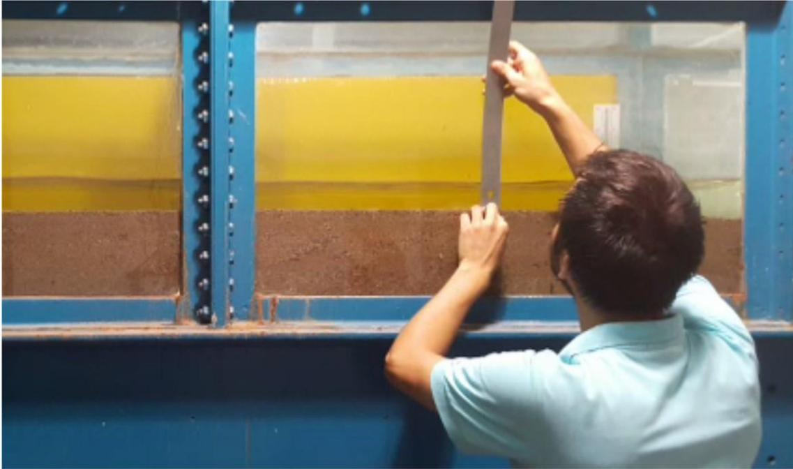
Figura 47. Medición de tirantes durante uno de los ensayos
