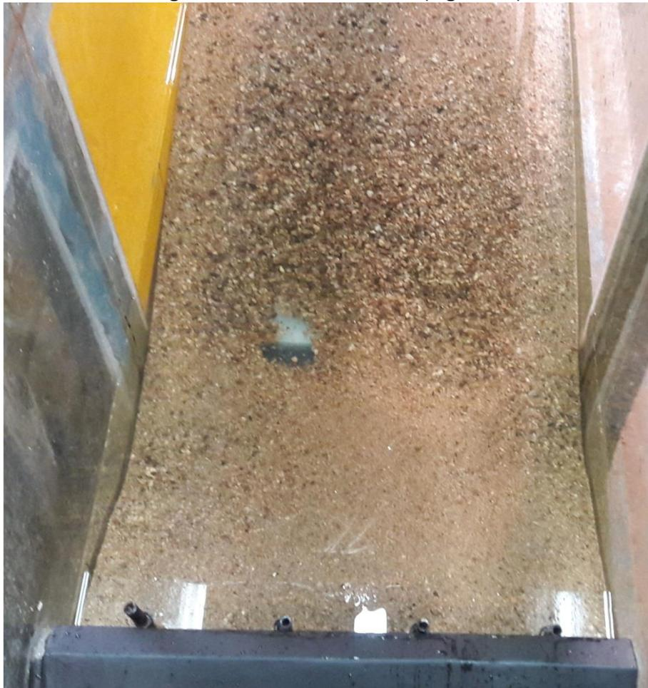
Figura 54. Erosión llegó hasta el fondo del canal
