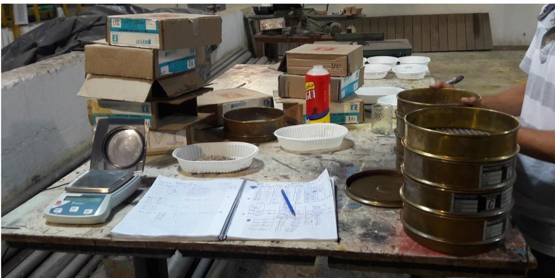
Figura 36. Ensayo granulométrico de muestras de ensayos
