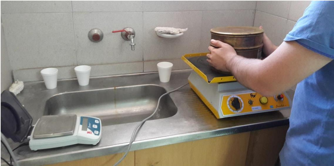
Figura 34. Ensayo granulométrico de la muestra inicial
