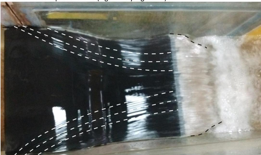
Figura 48. Estela formada sobre la estructura y alteración producida en el chorro
