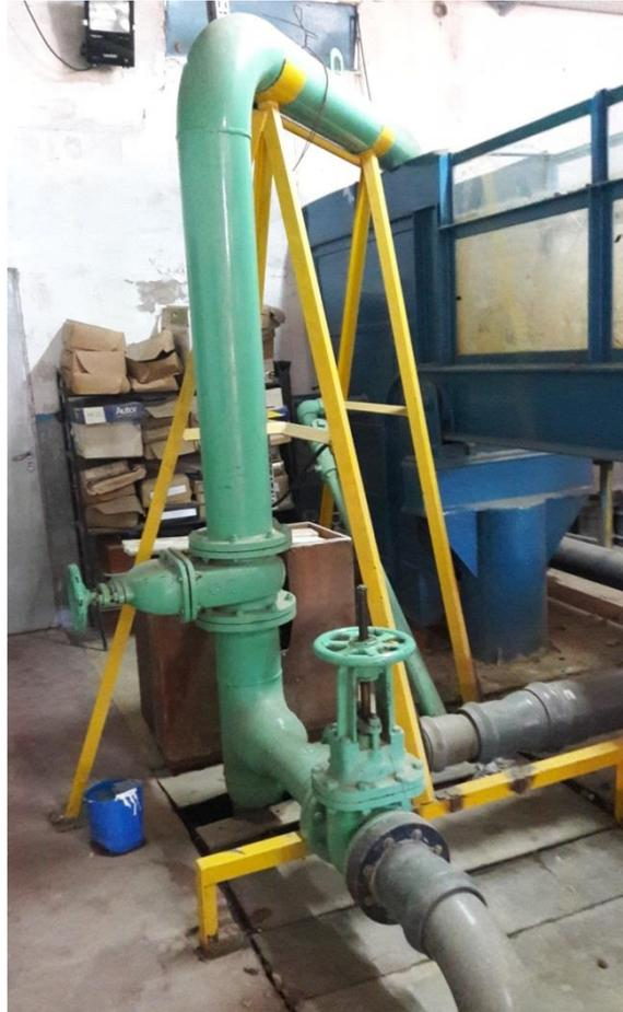
Figura 19. Cañería de alimentación al canal experimental
