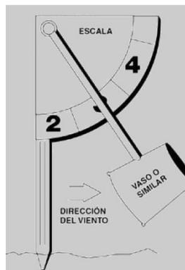
Fig. 4.1.2.1 – Anemómetro de Empuje
