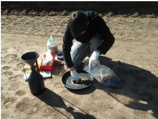
Ilustración 4.25 - Ensayo del cono de arena
