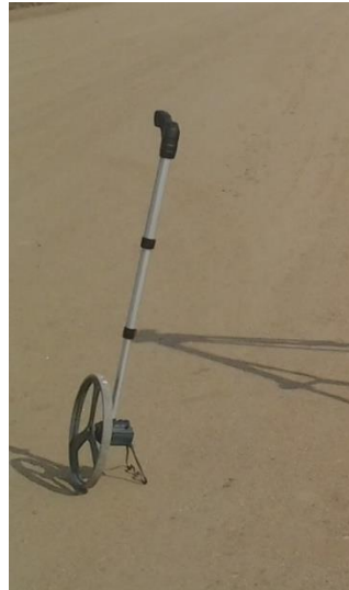
Ilustración 5.4 - Relevamiento con odómetro
