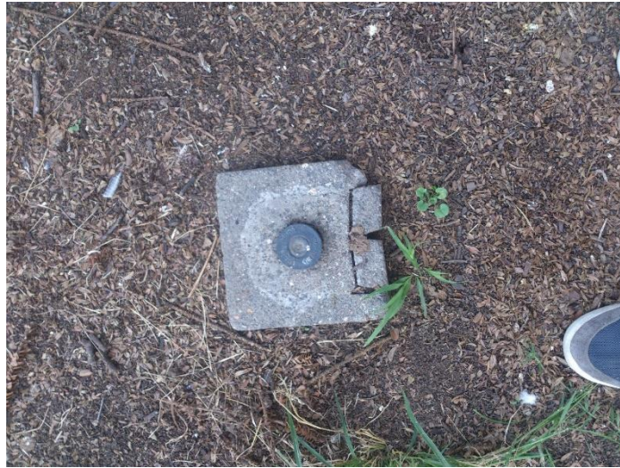
Figura 31: Punto Fijo – Mojón de Hormigón
