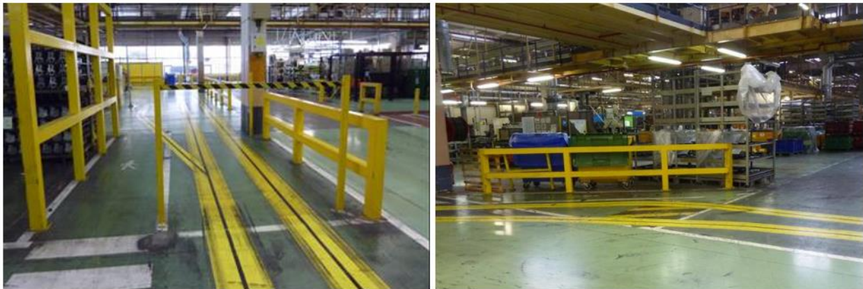
Figura 6.6: Ruta de recorrido de AGVs con cinta magnética y TAGs
