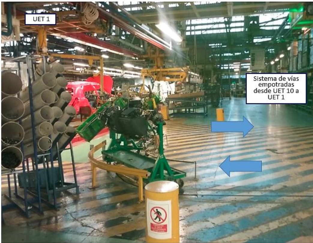
Figura 5.6: Sistema de vías empotradas de transporte de carros desde UET 1 a UET 10
