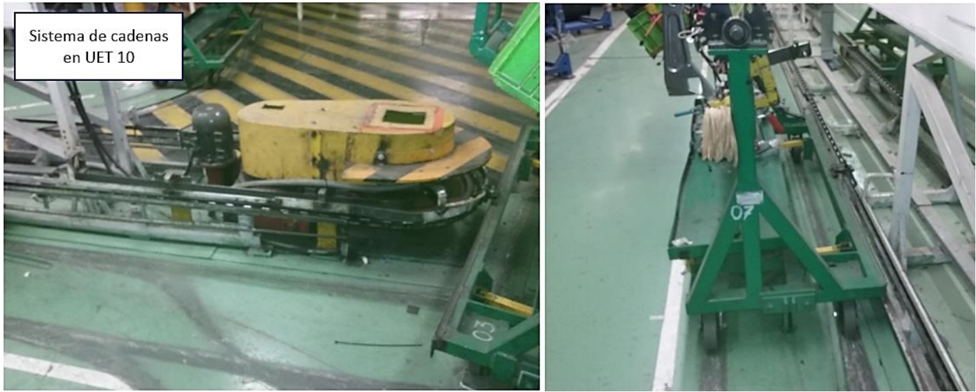
Figura 5.4: Sistema de cadenas de transporte de carros de armado
