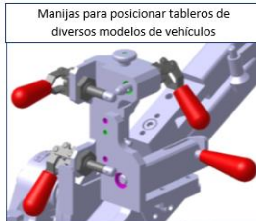
Figura 5.3: Manijas de carro de armado para fijar modelos A, B y C
