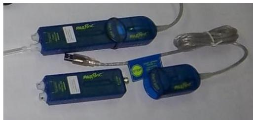
Figura 8: sensores de presión diferencial
