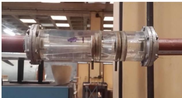
Figura 2: Caudalímetro de Tubo de Venturi
