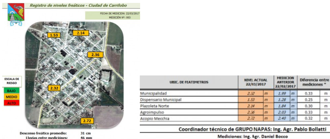
Imagen 10: Registro de niveles freáticos, 22/03/2017, Carrilobo. Fuente: Bollatti, 2017.
