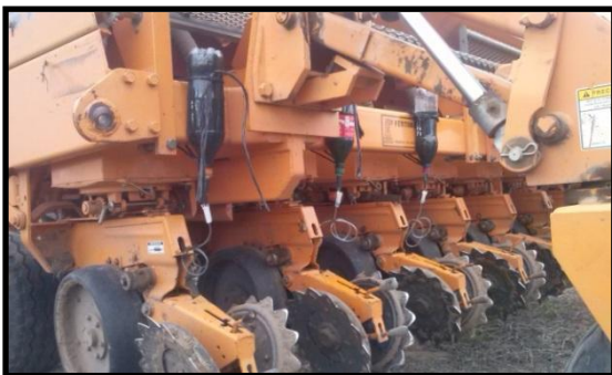
Imagen 1. Sembradora Agrometal de grano grueso de 9 surcos, perteneciente al parque de maquinaria del campo escuela FCA UNC, con sistema de chorreado incorporado.
