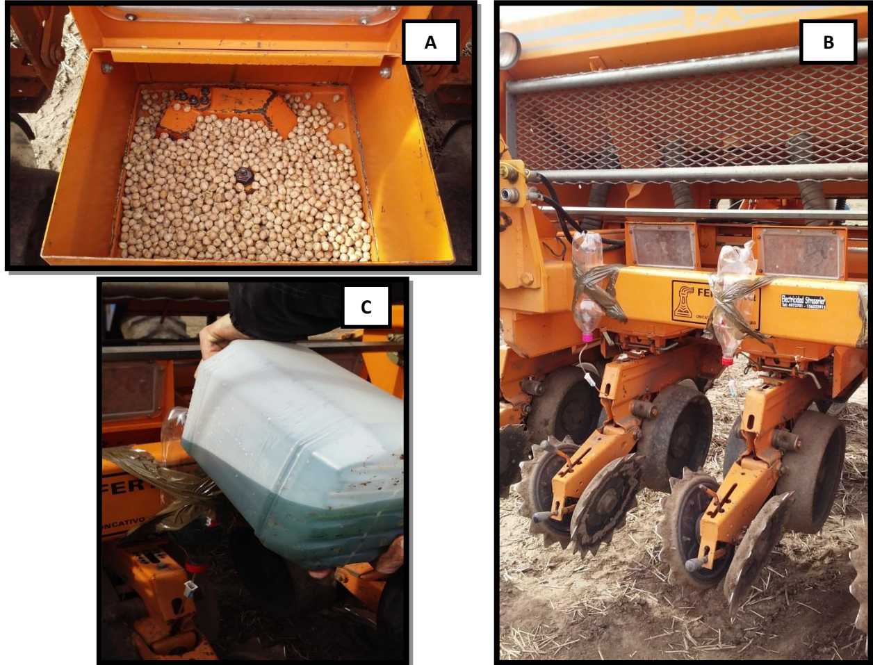
Figura 3. Imágenes de la siembra. A) Semillas en el cajón de la placa de siembra. B) Dispositivo dosificador de Trichoderma chorreado. C) Llenado de los dosificadores.
