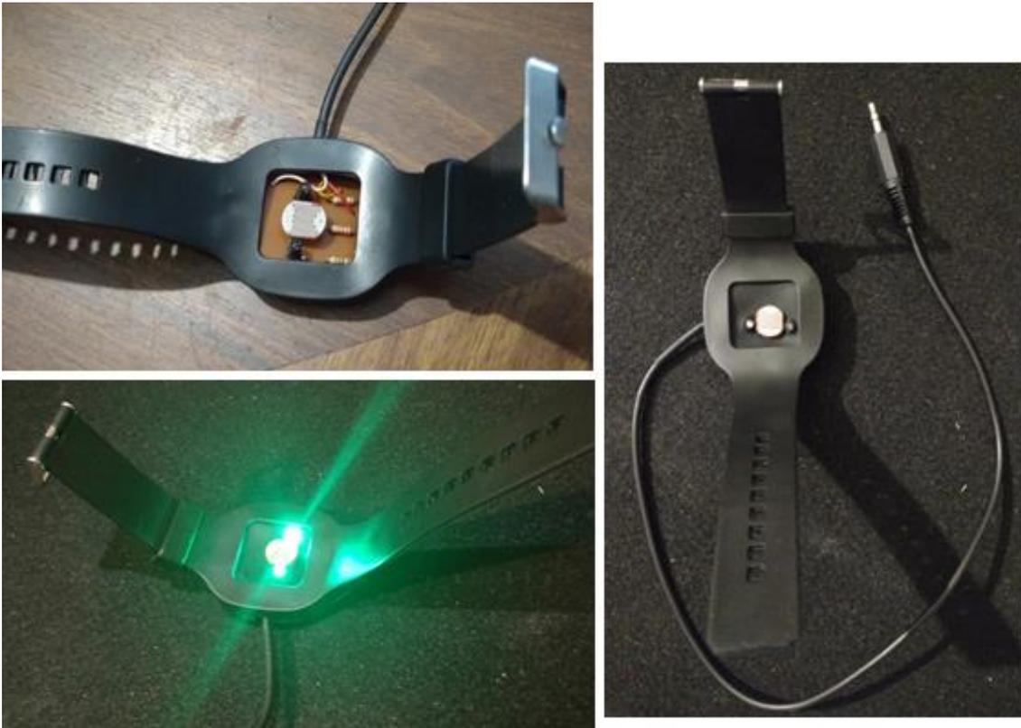
Ilustración 33 – Montaje y diseño externo de la etapa de medición de la frecuencia cardíaca
