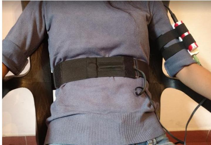
Ilustración 96 - Montaje de la medición del módulo de frecuencia respiratoria
