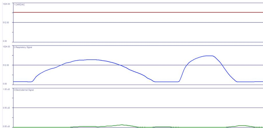
Ilustración 102 - Influencia de la señal respiratoria sobre la señal electrodermal luego de la compensación por cross-talk
