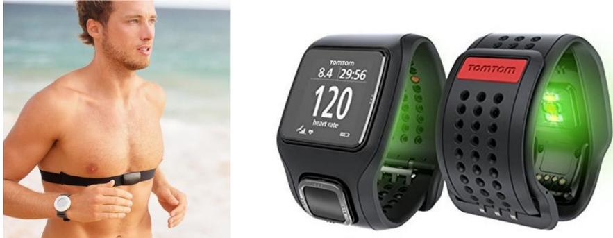
Ilustración 10 - Pulsómetro de banda pectoral (izquierda), pulsómetro óptico por fotopletismografía (derecha)<sup>24</sup>
