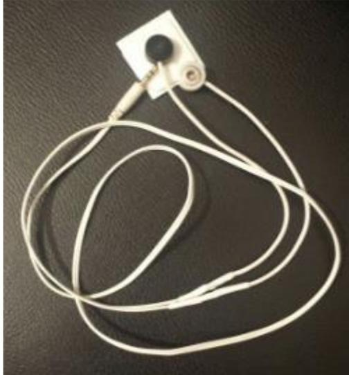
Ilustración 66 - Conectores de electrodos utilizados para actividad electrodermal
