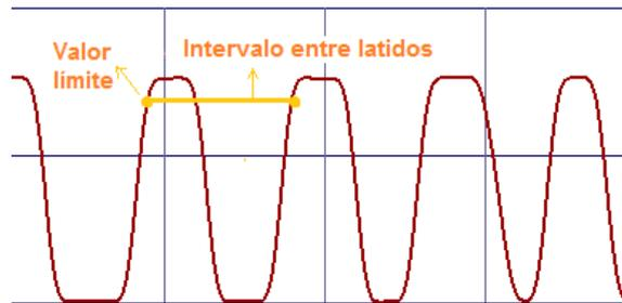
Ilustración 81 - Valor límite para el cálculo de la frecuencia cardíaca
