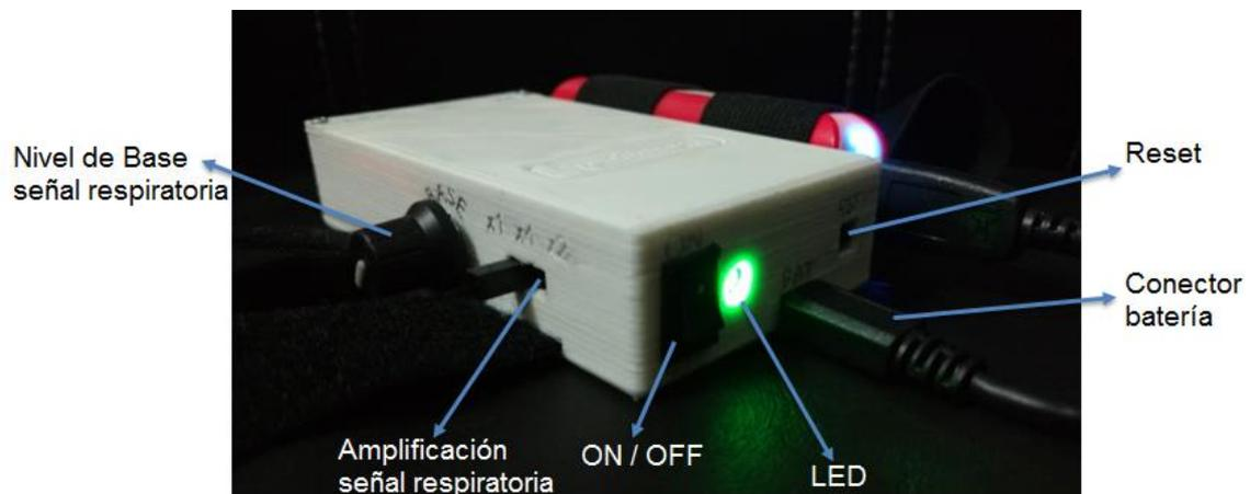
Ilustración 115 - Conectores e indicadores del equipo
