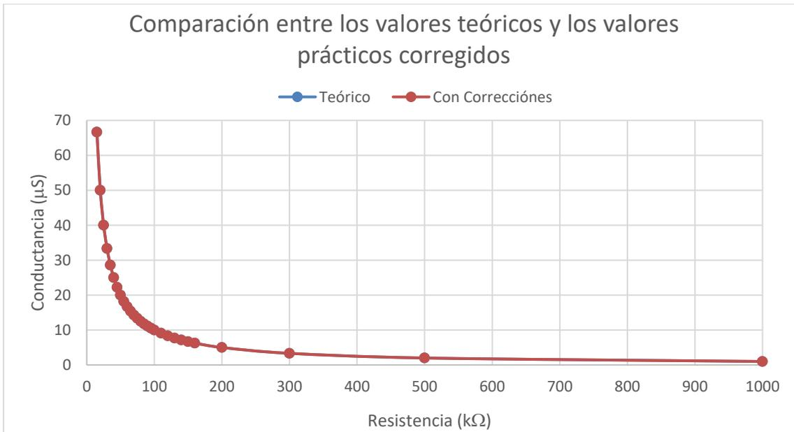
**Ilustración 106 - Comparación entre los valores teóricos y los valores medidos luego de la compensación lineal**
