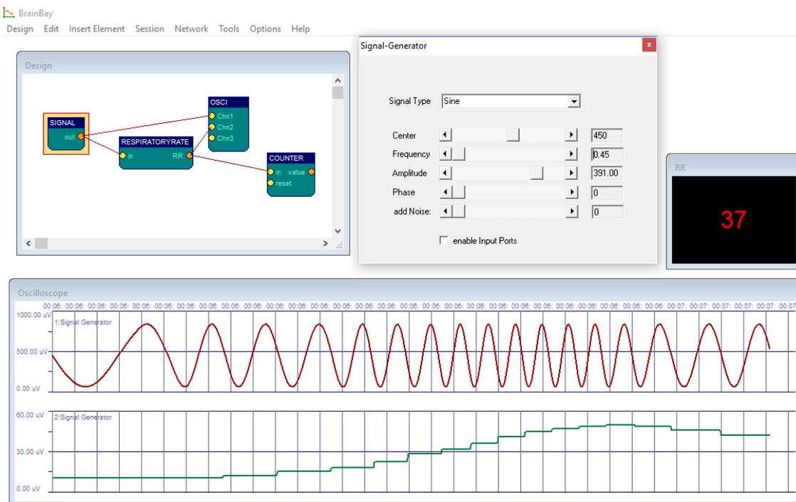
Ilustración 94 - Diseño implementado para la medición del elemento Respiratory Rate
