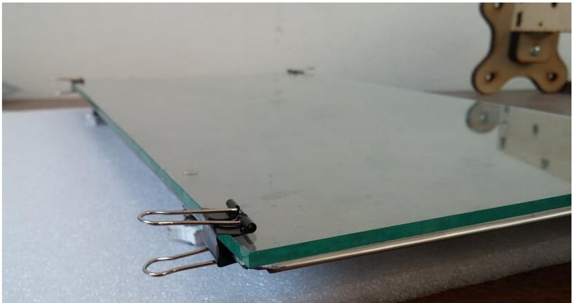
Ilustración 66: Plataforma de acero, vista anterior con un vidrio en su parte superior
