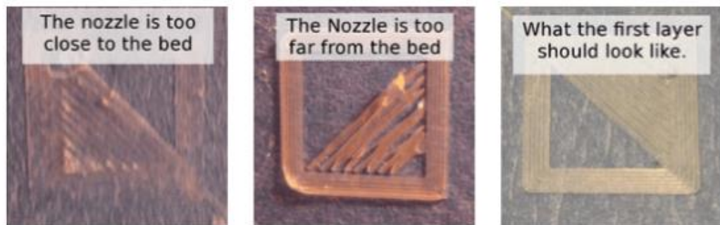
Ilustración 54: A la izquierda pico de extrusión cerca de la cama, en el medio impresión con un pico lejos de la plataforma de impresión, a la derecha situación ideal 48
