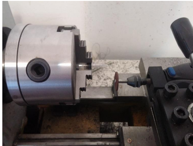
Ilustración 51: Adaptaciones del torno
