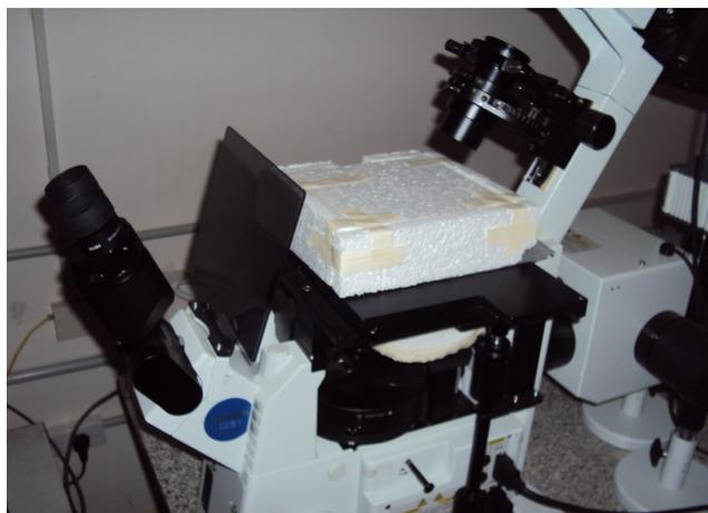
Figura 6: arreglo experimental en el microscopio para conservar la temperatura
