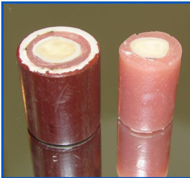
**Figura 19:** especímenes incluidos en resina acrílica para ser montados en máquina de ensayos universal.
