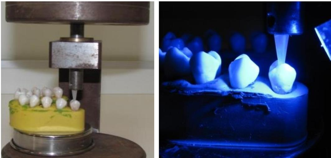
**Figura 46:** *cementado con la aplicación de una carga constante y fotopolimerización de los cementos.*
