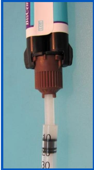
**Figura 33:** Carga de la mezcla de cemento en la jeringa de tuberculina para estandarizar el volumen de material.
