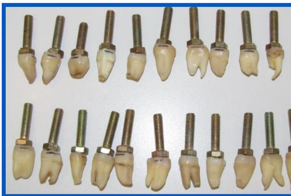
**Figura 15:** elementos dentarios preparados para ser montados en máquina de corte.
