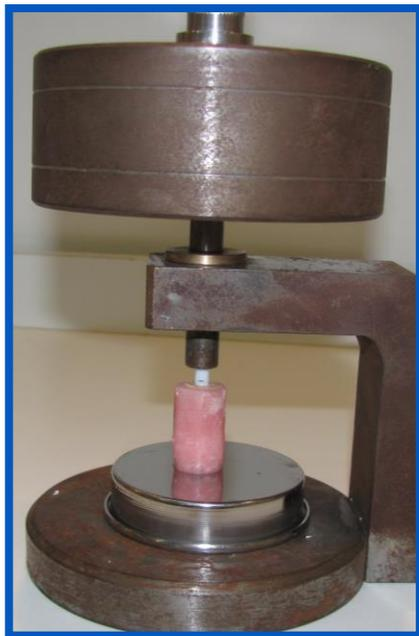
**Figura 25:** dispositivo ad-hoc estandarizador de fuerza de cementado, aplicando una carga constante de 25N.
