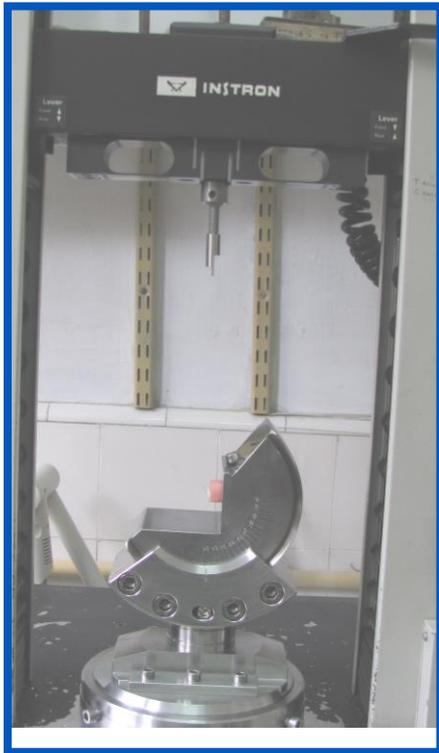
**Figura 29:** máquina de ensayos Universal (Instron. Cátedra de Materiales Dentales. FOUBA.)
