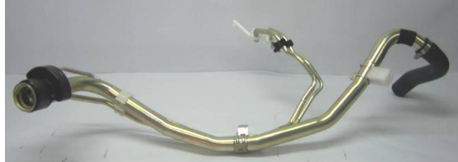
FIGURA 4. BOCA DE LLENADO COROLLA
