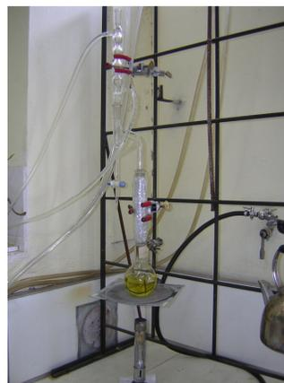
**Figura 3.7** – Equipo de destilación Clevenger modificado, con cámara de extracción separada (capacidad de la cámara: 5g)
