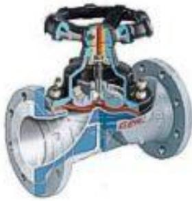
**Válvula Saunders:** Esta válvula, el obturador es una membrana flexible, que a través de un vástago unido a un servomotor, es forzada contra un resalte del cuerpo cerrando así el paso del fluido.
