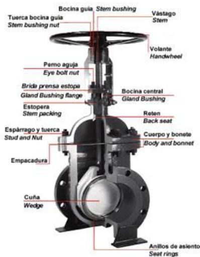
**Válvula esclusa:** Es una válvula que permite ser usada prácticamente en cualquier fluido, no producen importante pérdida de carga en la línea, no es aconsejable emplearla para reducir caudales, ya que las cavitaciones romperían el obturador, por lo que se usan abierta toda o cerrada toda. Es muy voluminosa (el volante está prácticamente desplazado un diámetro y medio del eje de la línea), y es de operación lenta.
