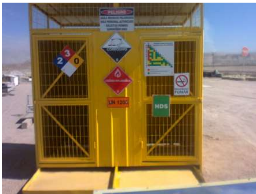
Figura 41. Ejemplo de jaula condicionada para almacenar residuos peligrosos o materiales peligrosos.
