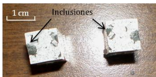
Figura 3.31. Superficie de fractura de una muestra ensayada por impacto para un lingote obtenido a partir del reciclado de virutas por el método FV2 sin desescoriado previo. A simple vista se observan inclusiones de gran tamaño (color negro).
