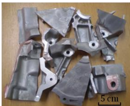
Figura 2.18. Trozos grandes, limpios y secos de la carcasa de aleación AZ91 utilizados para la refusión y comparación con el método de reciclado de las virutas.
