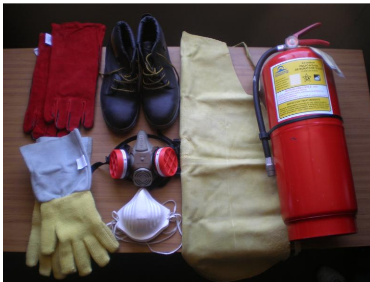
Figura 2.15. Elementos de seguridad e higiene utilizados durante los ensayos de fusión. De izquierda a derecha y de arriba hacia abajo: guantes de cuero, guantes de kevlar, botines de seguridad, máscara para gases, máscara para polvo, delantal de cuero, matafuegos.
