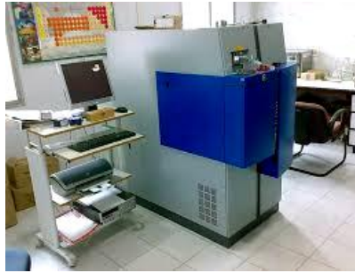
Figura 2.25. Espectrómetro de emisión de chispa marca Spectro, modelo Spectrolab-M8. Cortesía del Laboratorio Central de Volkswagen Argentina - Centro Industrial Córdoba.
