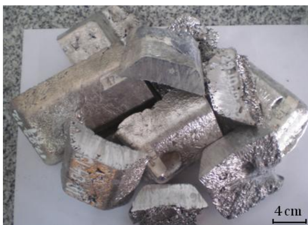
Figura 2.20. Restos de lingotes de las aleaciones recicladas por el método FV3 utilizados para las experiencias de purificación y desgasificación.
