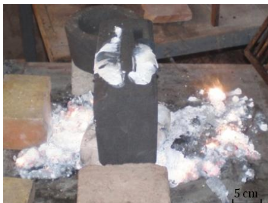
Figura 3.25. Proceso de colada con fallas en el procedimiento experimental (ensayo número 1 - Tabla 3.3). Se observa MgO (blanco) junto a las llamas incandescentes producto de la oxidación.
