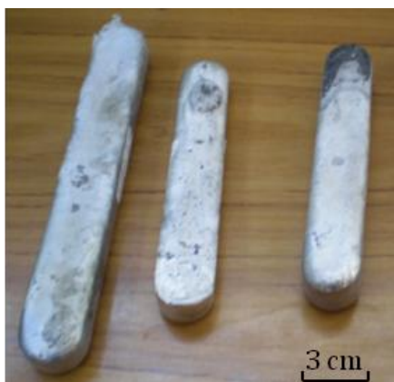
Figura 3.15. Aspecto visual de algunos lingotes de la aleación fundida a partir de trozos grandes, limpios y secos de la aleación original AZ91.
