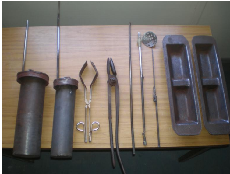
Figura 2.14. Herramientas de fusión y manipulación utilizadas durante las experiencias. De izquierda a derecha: crisol y lanza para refusión, crisol y lanza para reciclado, pinza para colar, pinza para manipular crisoles, barra de pudelar, lanza para desgasificación, espumadera para desescoriar, lingoteras de fundición de hierro para colar.
