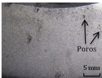
Figura 3.17. Aleación fundida a partir de trozos grandes y limpios de la aleación AZ91.
