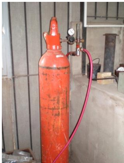
Figura 2.9. Instalación de tubo de gas, reductor de presión y flujómetro.
