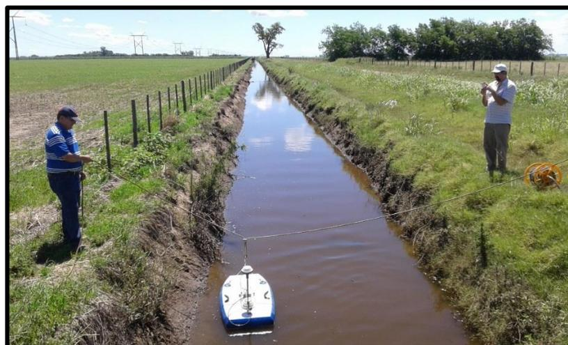
Figura 67: Medición con ADCP en sección de aforo 4: Tributario 2.
