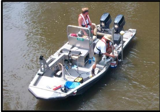
Figura 46: Medición de caudales con ADCP desde embarcaciones.
