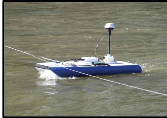
Figura 47: Medición de caudales con ADCP desde plataformas móviles comandadas.
