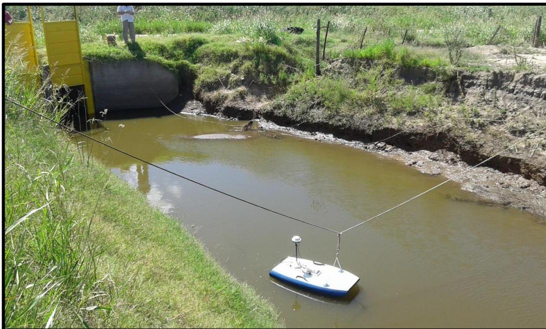
Figura 70: Medición con ADCP en sección de aforo 5: Tributario 3.
