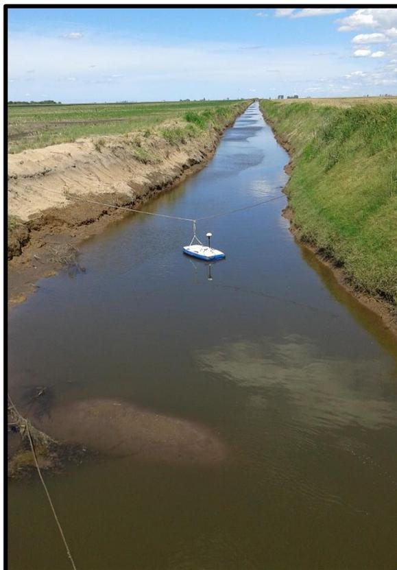
Figura 73: Medición con ADCP en sección de aforo 6: Aguas Abajo del Tributario 3.
