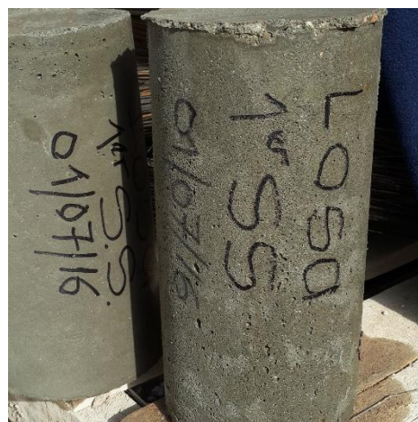
Figura 4.3.34-Probetas de hormigón para ensayar
